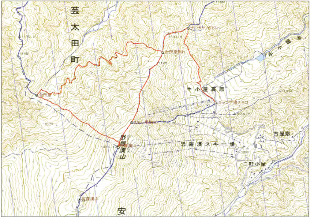
青い斜線は磁北線。磁北（磁石の指す北）と真北（実際の北）は少し（ここでは西に7°）ずれているため、山行では磁北線を書き込んだ地図を使うことが多い。磁北線と磁北線の間は約500m。
