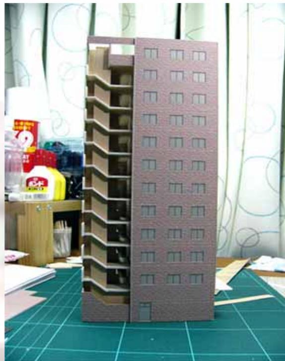
6. 縮尺率の大きなマンション外階段は、むやみに表現しようとせずスロープ表現します。
